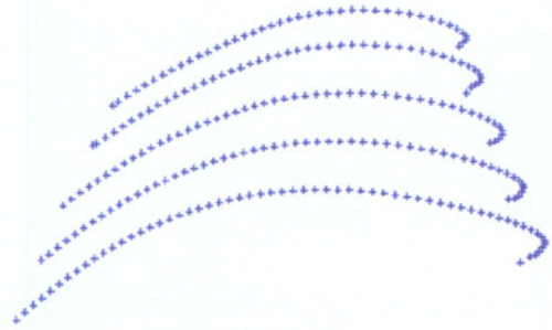
图4 重构模式下测量机测量数据点
